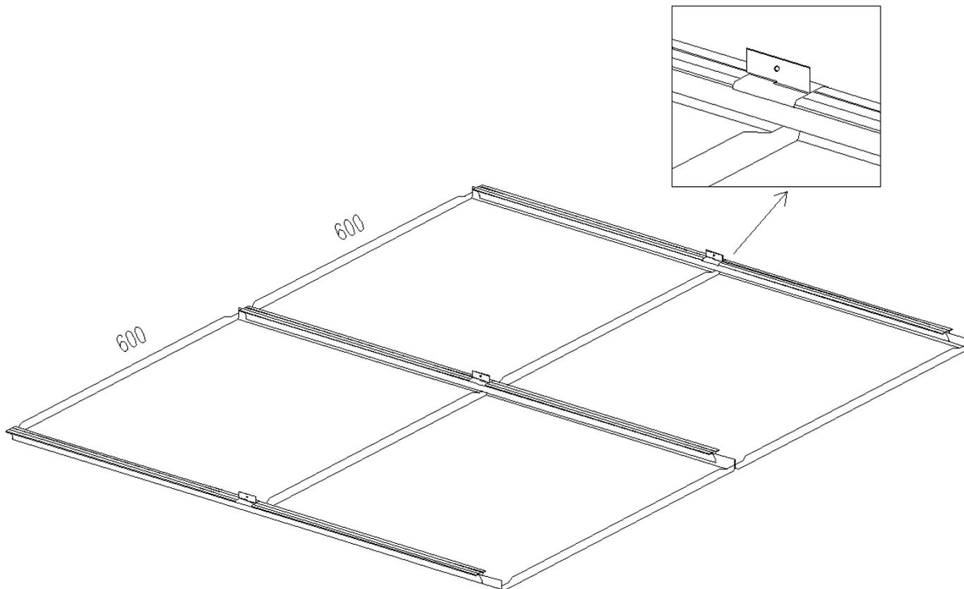
**PANNELLI A STRUTTURA NASCOSTA CON DOPPIA STRUTTURA**
